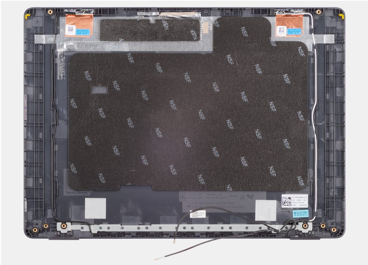
Abbildung 86. Entfernen der Baugruppe der hinteren Bildschirmabdeckung
