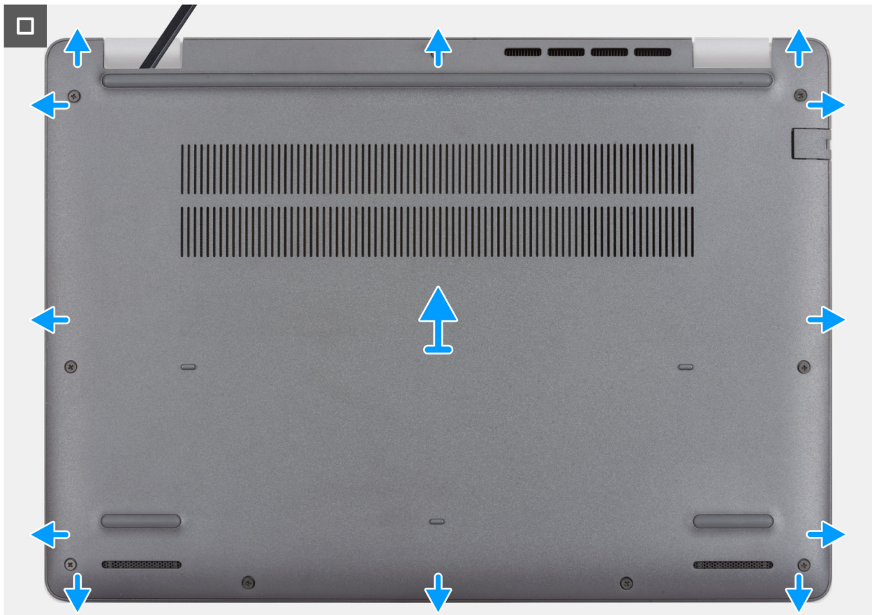
Abbildung 12. Entfernen der Bodenabdeckung
