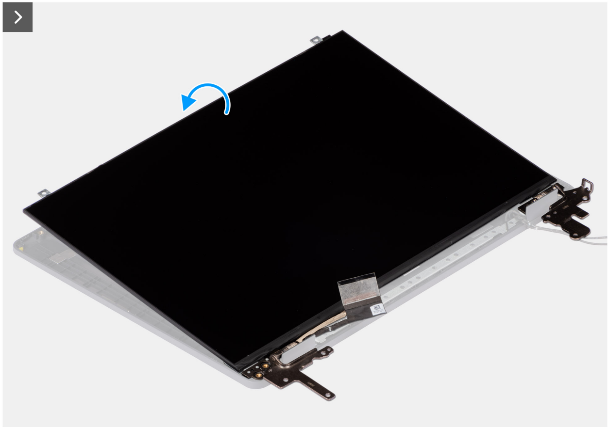
Abbildung 80. Installieren der Bildschirmbaugruppe
