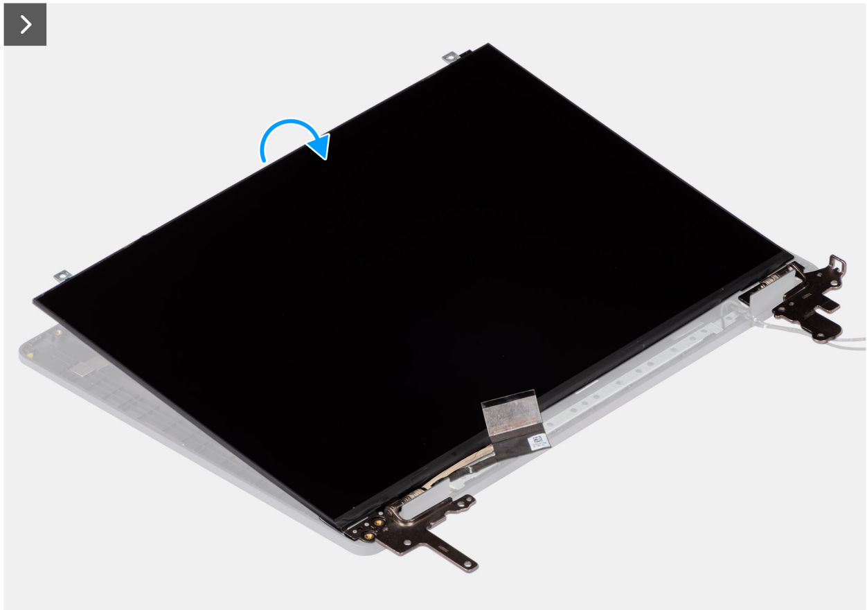
Abbildung 75. Entfernen der Bildschirmbaugruppe
