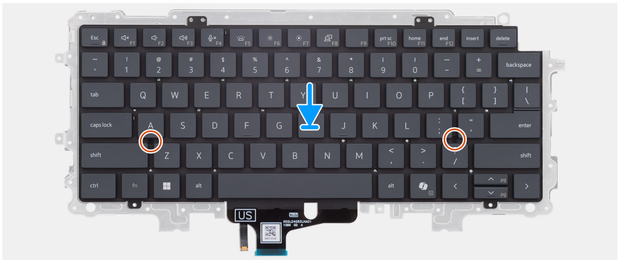
Abbildung 59. Installieren der Tastaturstützplatte
