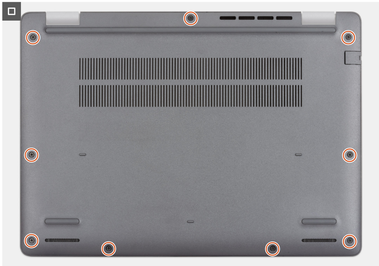
Abbildung 16. Anbringen der Bodenabdeckung
