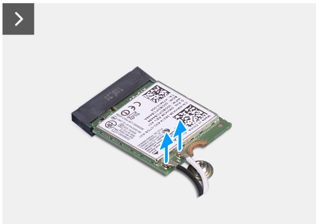
Abbildung 25. Entfernen der Wireless-Karte
