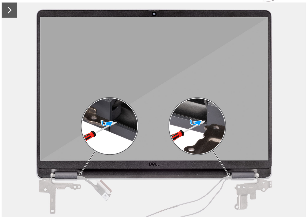
Abbildung 67. Entfernen der Bildschirmblende
