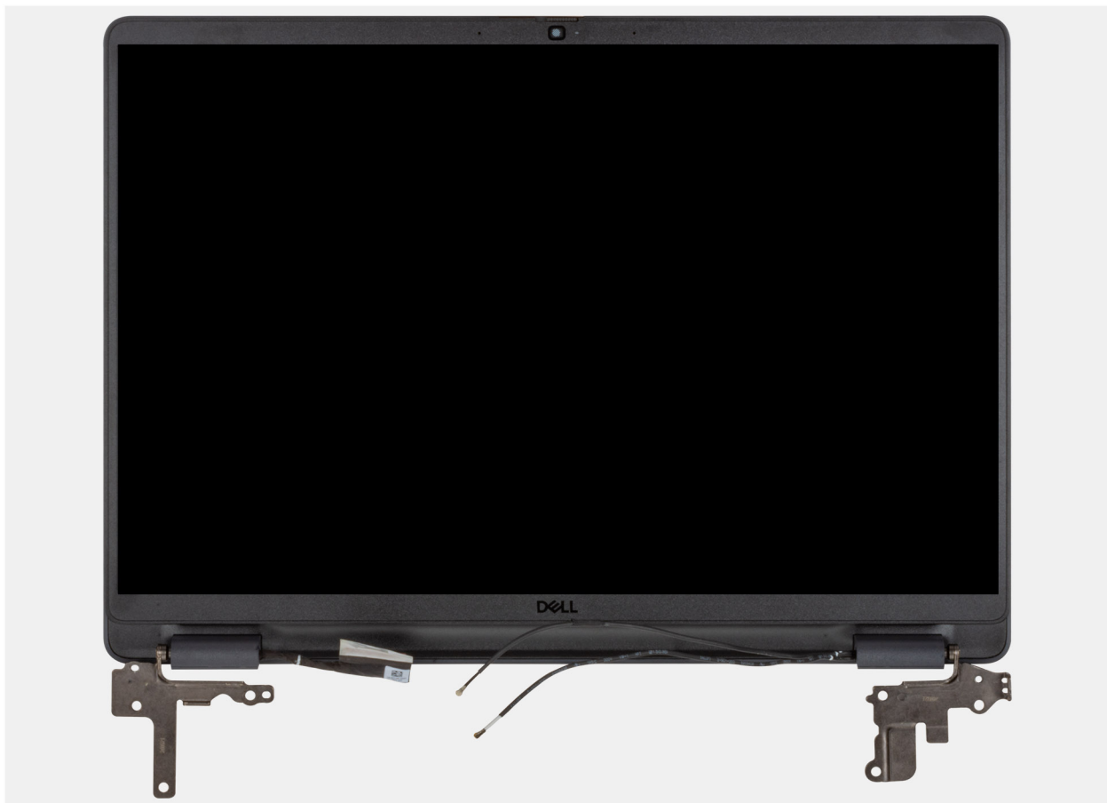
Abbildung 64. Entfernen der Bildschirmbaugruppe
