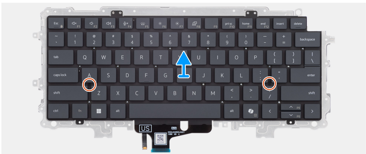
Abbildung 56. Entfernen der Tastaturstützplatte
