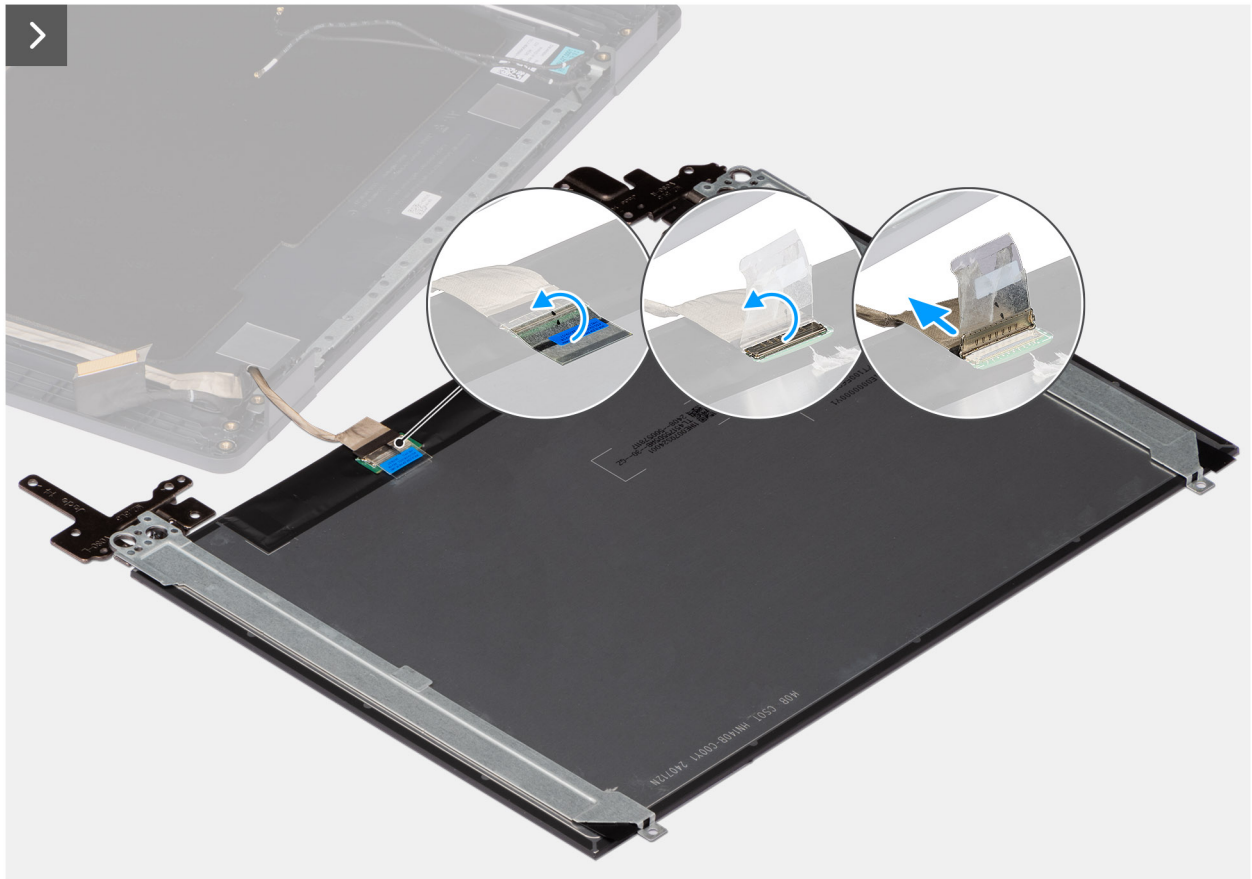
Abbildung 76. Entfernen der Bildschirmbaugruppe
