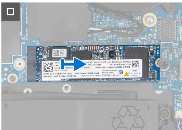
Abbildung 28. Entfernen des M.2 2280-SSD-Laufwerks aus dem Steckplatz SSD1
