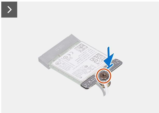
Abbildung 35. Installieren der Wireless-Karte
