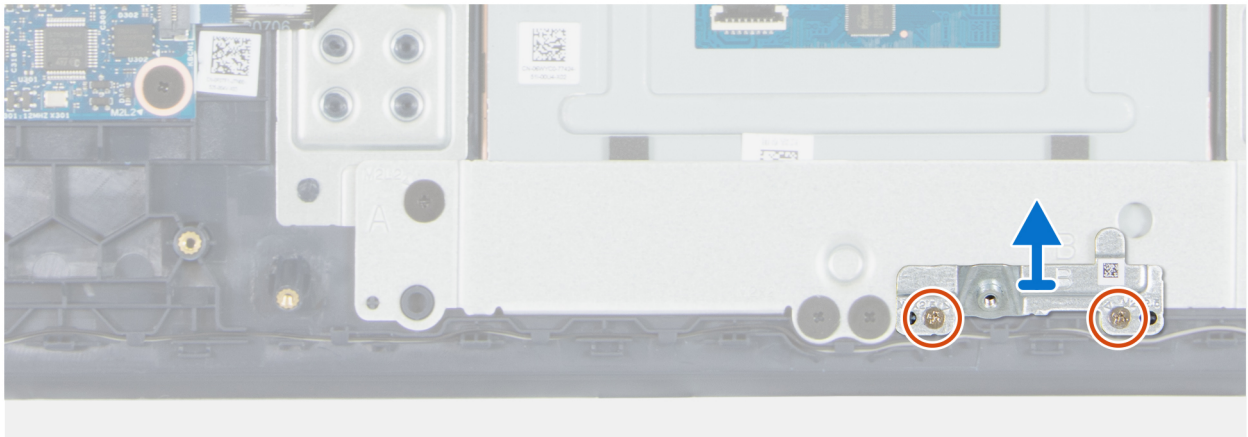
Abbildung 42. Entfernen der Akkuhalterung
