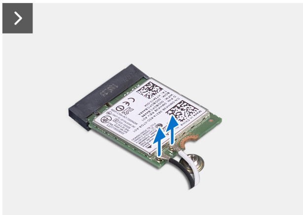
Abbildung 34. Entfernen der Wireless-Karte
