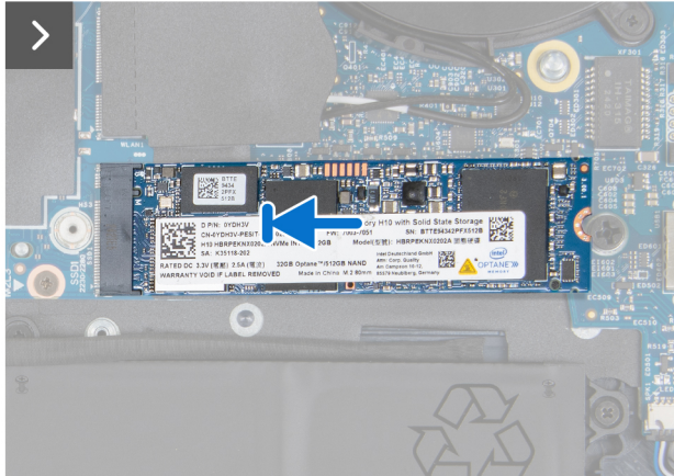
Abbildung 29. Installieren des M.2-2280-SSD-Laufwerks im Steckplatz SSD1
