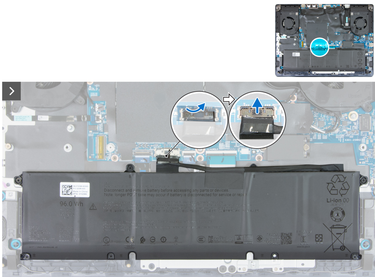
Abbildung 13. Trennen des Akkukabels
