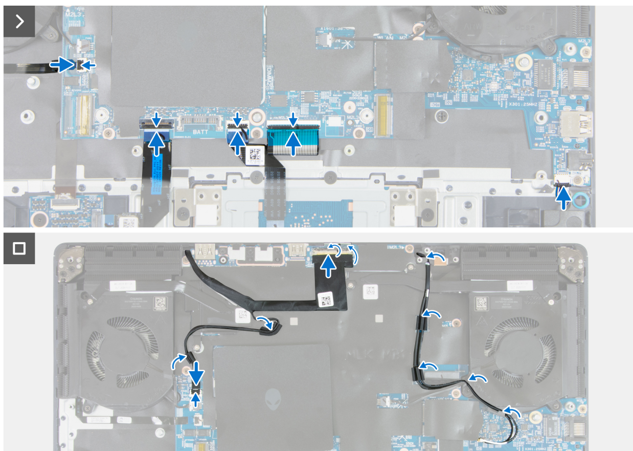
Abbildung 71. Einbauen der Hauptplatine (bei Computern mit VR-Kühlkörpern)
