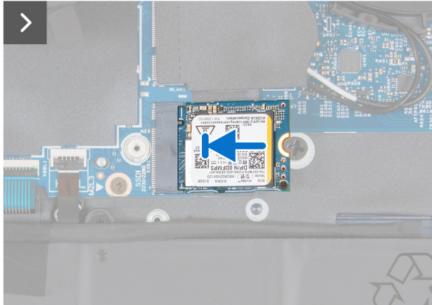
Abbildung 25. Installieren des M.2 2230-SSD-Laufwerks im Steckplatz SSD1
