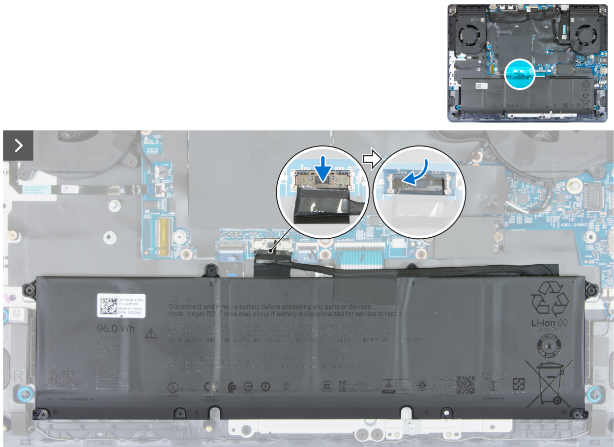
Abbildung 15. Verbinden des Akkukabels
