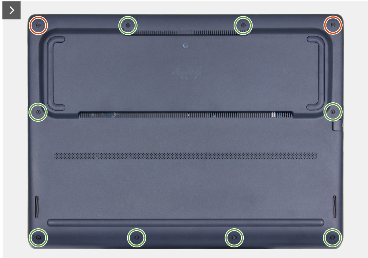
Abbildung 10. Entfernen der acht Schrauben an der Bodenabdeckung
