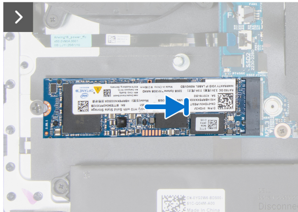
Abbildung 31. Installieren des M.2 2280-SSD-Laufwerks im Steckplatz SSD2
