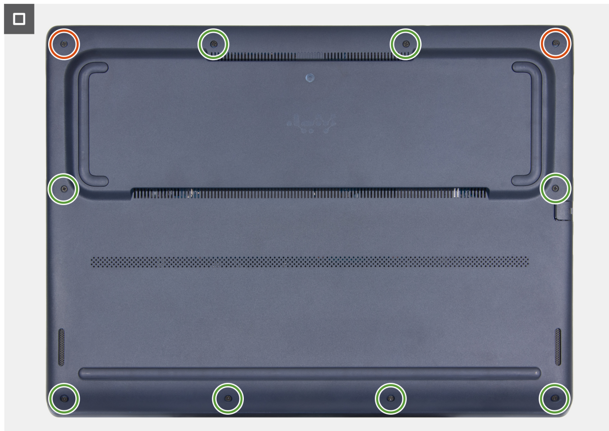
Abbildung 17. Anbringen der Bodenabdeckung
