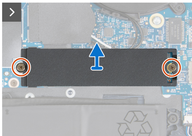
Abbildung 28. Entfernen des M.2 2280-SSD-Laufwerks aus dem Steckplatz SSD1
