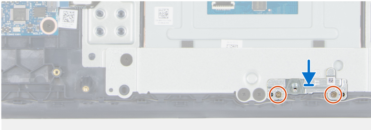
Abbildung 43. Installieren der Akkuhalterung
