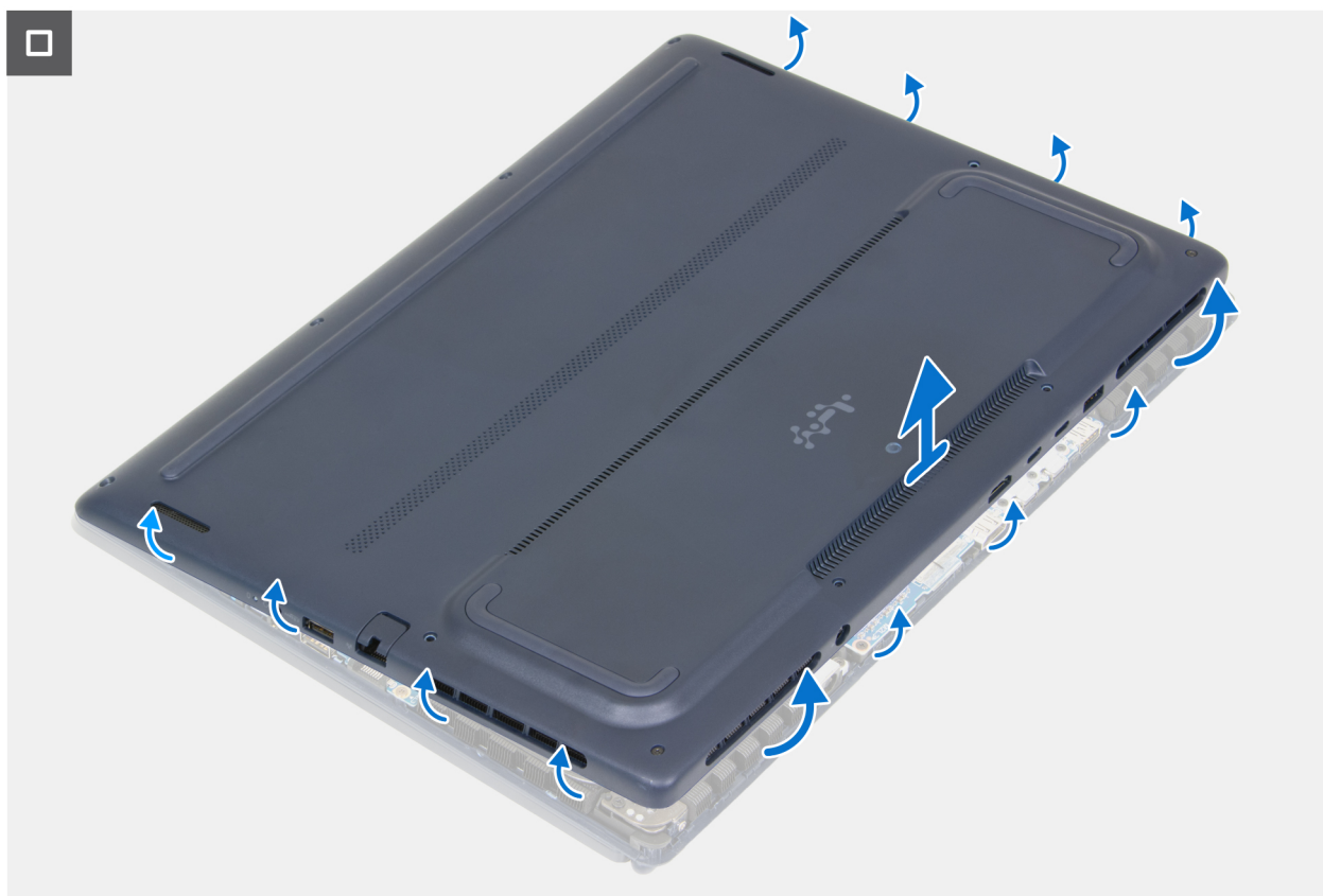
Abbildung 12. Entfernen der Bodenabdeckung
