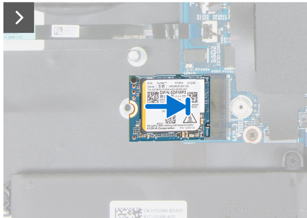
Abbildung 27. Installieren des M.2 2230-SSD im Steckplatz SSD2
